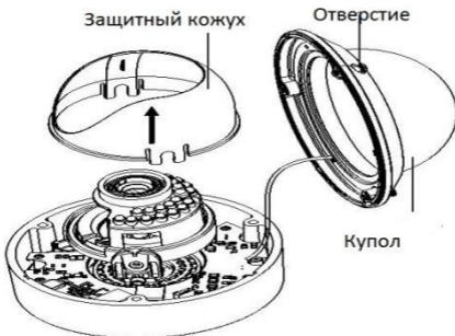
Рисунок 2-1 Снятие купола и защитного кожуха
