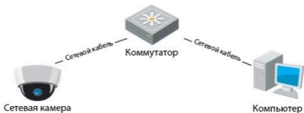
Рисунок 3-2 Соединение через коммутатор или роутер
