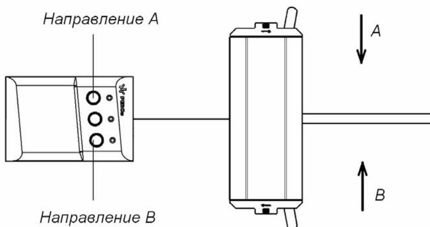
**Рисунок 6. Стандартная ориентация ПДУ относительно стойки ЭП**
