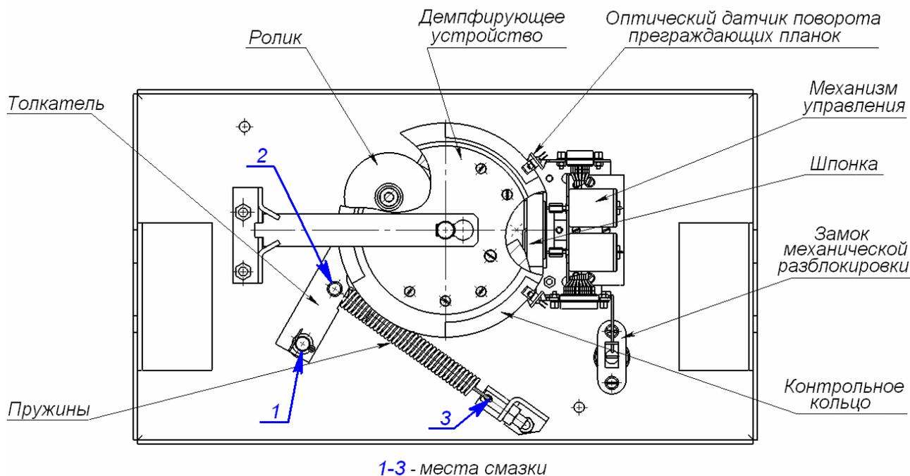
**Рисунок 14. Расположение внутренних деталей и узлов стойки ЭП**
