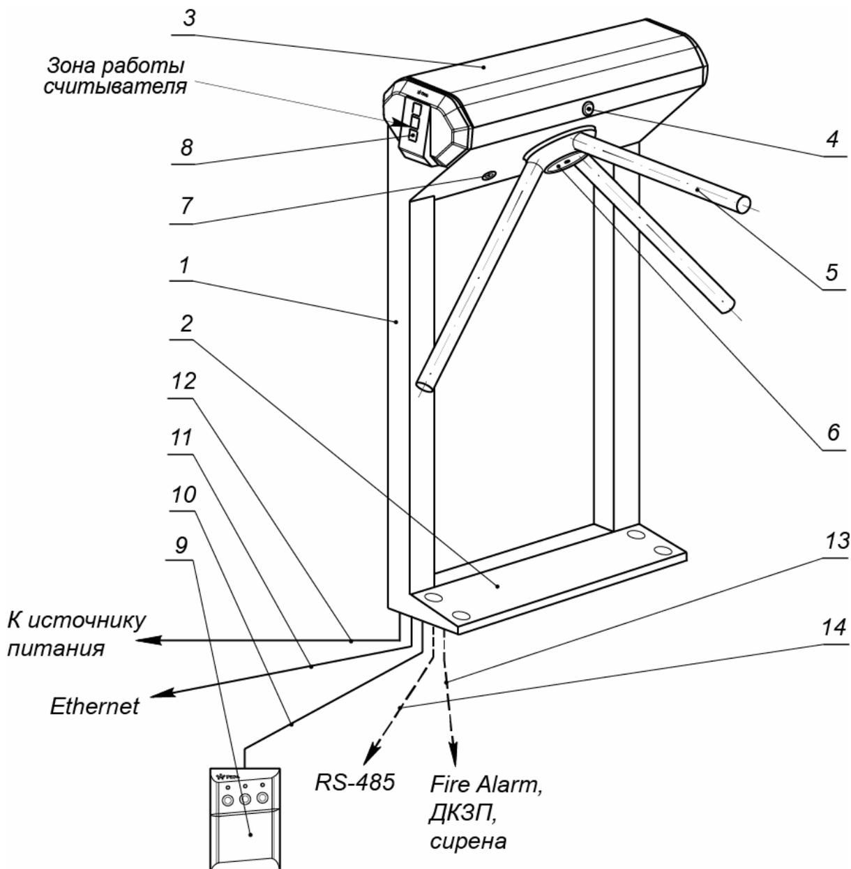
Рисунок 2. Устройство ЭП
