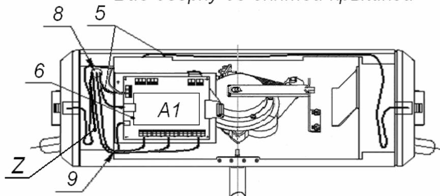
**Рисунок 10. Схема прокладки кабелей в стойке ЭП**
